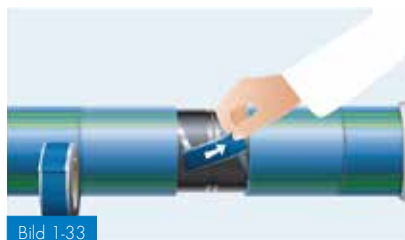
Bild 1-33 Återupprättande av elektrisk anslutning
