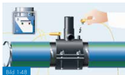
Bild 1-48 Svetsning i enlighet med DVS 2207, del 1
