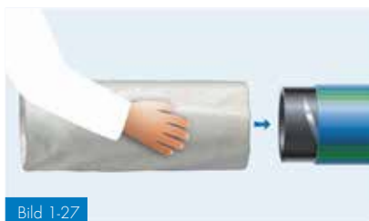
Bild 1-27 Montera krympmuffen innan rörskarven görs, och ta inte bort skyddsfolien
