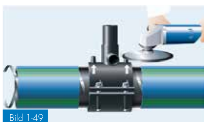
Bild 1-49 Borttagning av kontaktstiften med lämpligt verktyg
