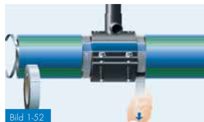
Bild 1-52 Isolering av elektrisk anslutning
