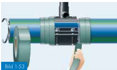
Bild 1-53 Vattentät isolering av elektrisk skarv
