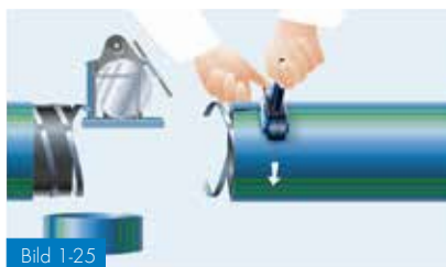
Bild 1-25 Borttagning av manteln med avskalningsverktygen Extena M10 / M10 maxi
