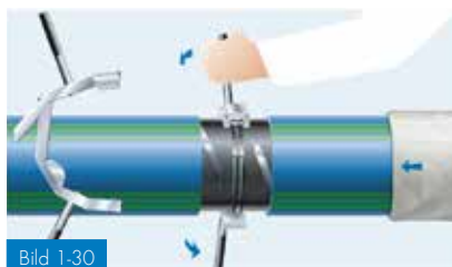
Bild 1-30 Borttagning av svetsvulst med utvändig vulstskärare
