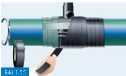
Bild 1-55 Mekaniskt skydd av isoleringsskiktet
