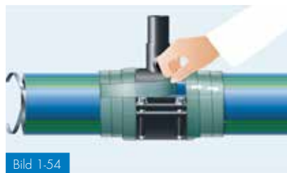
Bild 1-54 Vattentät isolering av elektrisk skarv
