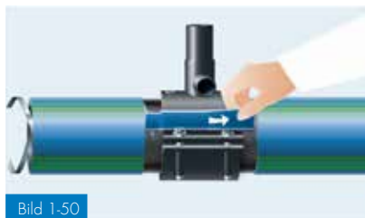
Bild 1-50 Återupprättande av elektrisk anslutning
