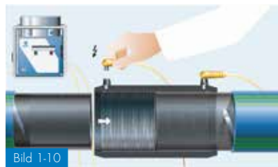
Bild 1-10 Steg 4: Svetsning i enlighet med DVS 2207, del 1
