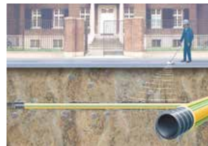
Bild 1-60: Detektering av installerad rörledning
