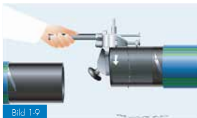
Bild 1-9 Borttagning av oxidskiktet med roterande rörskrapa
