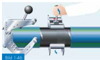
Bild 1-46 Borttagning av oxidskiktet med lämplig rörskrapa
