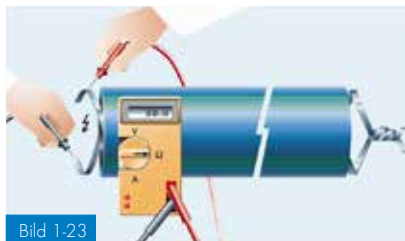
Bild 1-23 Upprättande av en elektriskt ledande brygga på första rörsektionen
