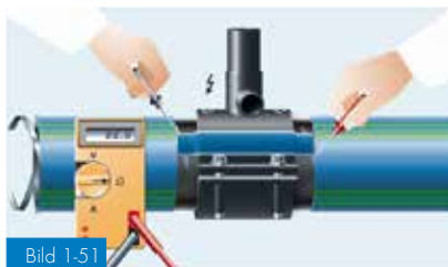
Bild 1-51 Mätning av motstånd (Ohm)
