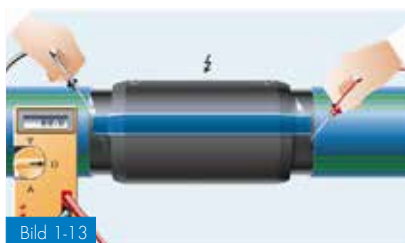
Bild 1-13 Steg 9: Mätning av motstånd (Ohm)
