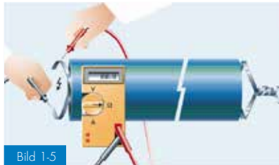
Bild 1-5 Steg 1: Upprättande av en elektriskt ledande brygga på första rörsektionen
