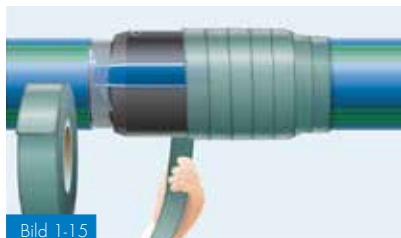
Bild 1-15 Steg 1: Vattentät isolering av elektrisk skarv (dimensioner upp till YD 90 mm)
