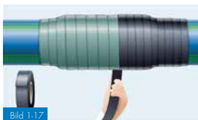
Bild 1-17 Steg 2: Exempel: Mekaniskt skydd av isoleringsskiktet
