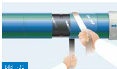
Bild 1-32 Slipning av krympområdet på manteln radiellt med sandpapper
