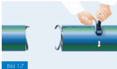
Bild 1-7 Borttagning av manteln med avskalningsverktygen Extena M10 / M10 maxi
