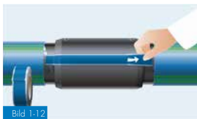
Bild 1-12 Steg 6-8: Återupprättande av elektrisk anslutning
