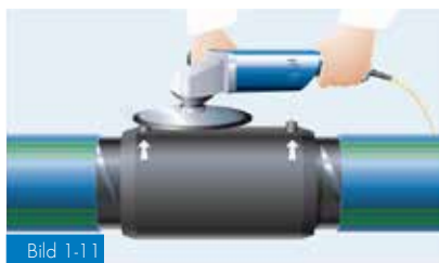
Bild 1-11 Steg 5: Borttagning av kontaktstiften
