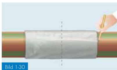
Bild 1-30 Centrering av krypmuffen
