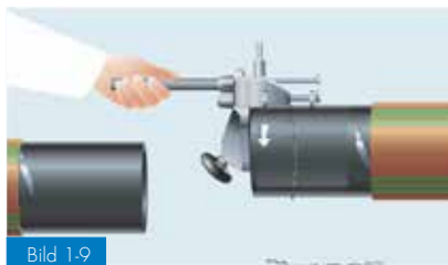
Bild 1-9 Borttagning av oxidskiktet med roterande rörsrapa
