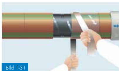
Bild 1-31 Slipning av krympområdet på manteln radiellt med sandpapper
