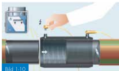
Bild 1-10 Steg 4: Svetsning i enlighet med DVS 2207, del 1
