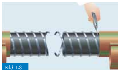
Bild 1-8 Kapning av ledande band - minst 20 mm måste lämnas kvar på röret för vidare bearbetning
