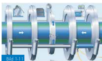
Bild 1-11 Hyvling av rörändar , där eventuell smuts från rörens skarvytor försiktigt avlägsnas
