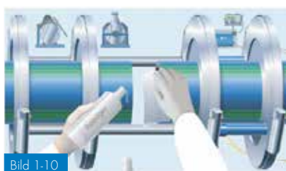
Bild 1-10 Rengöring av rör med hjälp av PE-rengöringsmedel och rent, ofärgat, luddfritt paper
