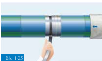
Bild 1-25 Lindning av svetsområdet med aluminiumtejp
