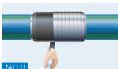
Bild 1-11 Lindning av aluminiumtejp över elektrosvetsmuffen
