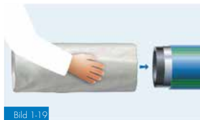
Bild 1-19 Montera krypmuffen innan rörskarven görs, och ta inte bort skyddsfolien
