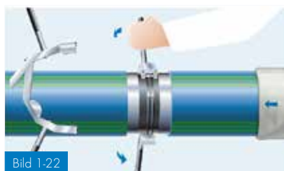
Bild 1-22 Borttagning av svetsvulst med utvändig vulstborttagare
