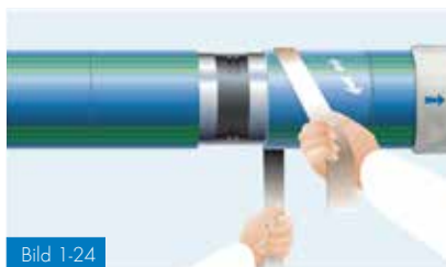
Bild 1-24 Slipa krympområdet på krympmuffen med sandpapper.
