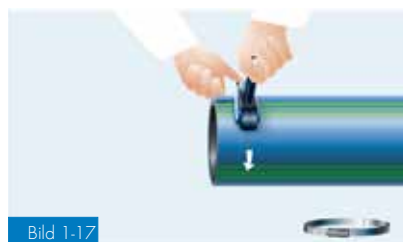
Bild 1-17 Borttagning av mantel med lämpliga avskalningsverktyg
