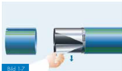
Bild 1-7 Borttagning av aluminiumbarriären med hjälp av en slangklämma
