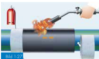
Bild 1-27 Påkrympning av krympmuffen med mjuk gaslåga
