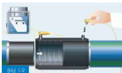
Bild 1-9 Svetsning i enlighet med DVS 2207, del 1
