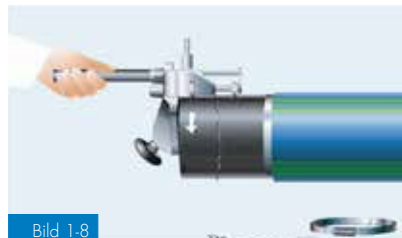
Bild 1-8 Borttagning av oxidskiktet med roterande rörskrapa
