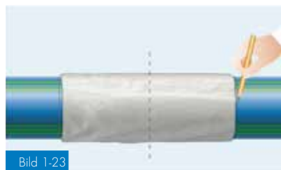
Bild 1-23 Centrerung av krypmuffen
