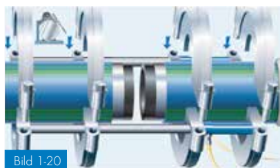
Bild 1-20 Montering av specialsveltsbackar
