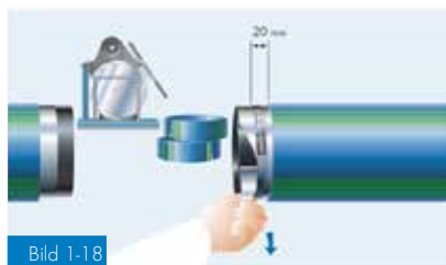
Bild 1-18 Borttagning av aluminiumbarriär
