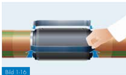
Bild 1-16 Applicering av två längder elektriskt ledande aluminiumtejp
