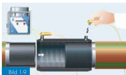
Bild 1-9 Svetsning i enlighet med DVS 2207, del 1
