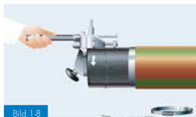
Bild 1-8 Borttagning av oxidskiktet med roterande rörskrapa
