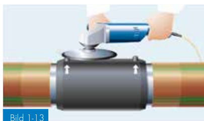
Bild 1-13 Borttagning av kontaktstiften
