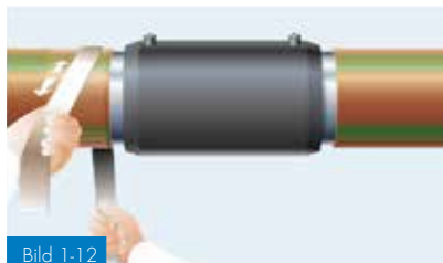
Bild 1-12 Slipning av manteln vid krympmuff
