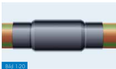
Bild 1-20 Elektrosvetsmuff skyddad av krympmuff
