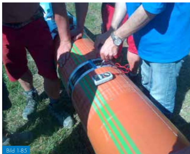
Bild 1-85 Mätning av elektriskt motstånd ( <0,5 \text{ Ohm} )
