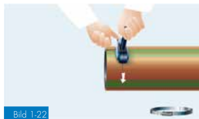
Bild 1-22 Borttagning av manteln med avskalningsverktygen Extena M10 / M10 maxi
